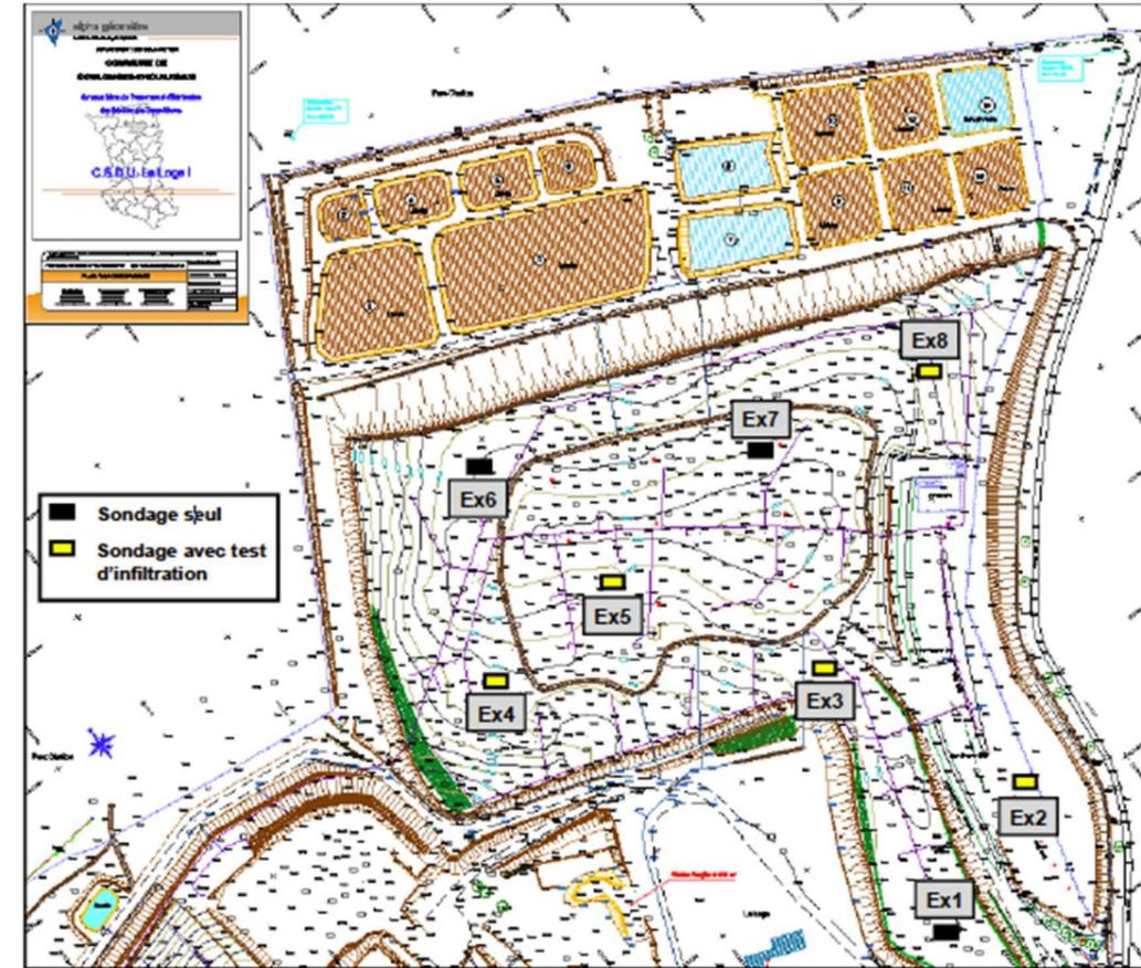
Localisation des sondages et des tests d'infiltration réalisés (Loge 1) – Source : EAUGEO et SOND&EAU, 2017
